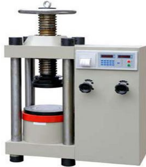
Rajah 4 : Alat Ujian Kekuatan Lenturan
